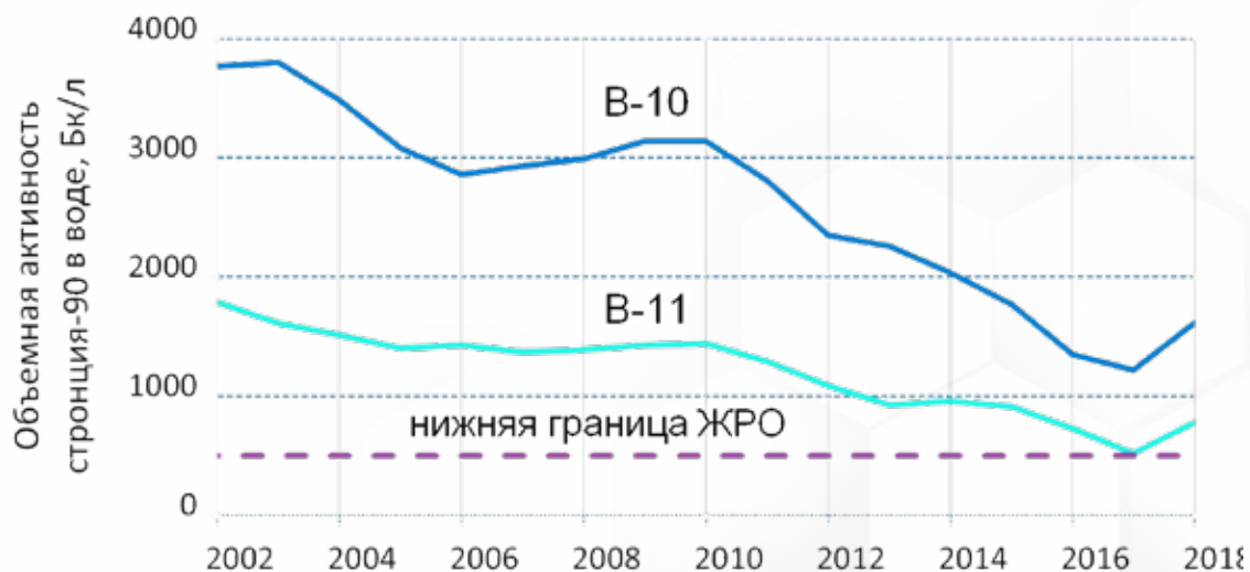
Диаграмма 9 – Изменение среднегодовой объёмной активности 90 Sr в воде водоёмов В-10 и В-11
