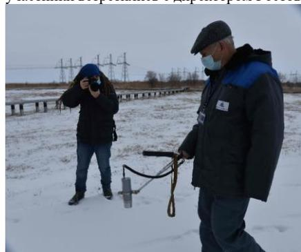
Фото 23. Проверка радиационного фона на Ростовской АЭС в рамках экологического тура
