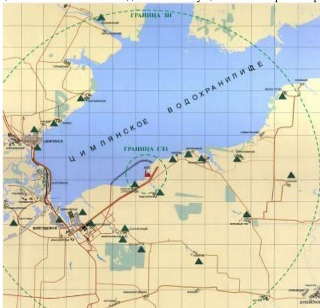
Рис.5. Схема размещения постов контроля АСКРО в СЗЗ и ЗН.
