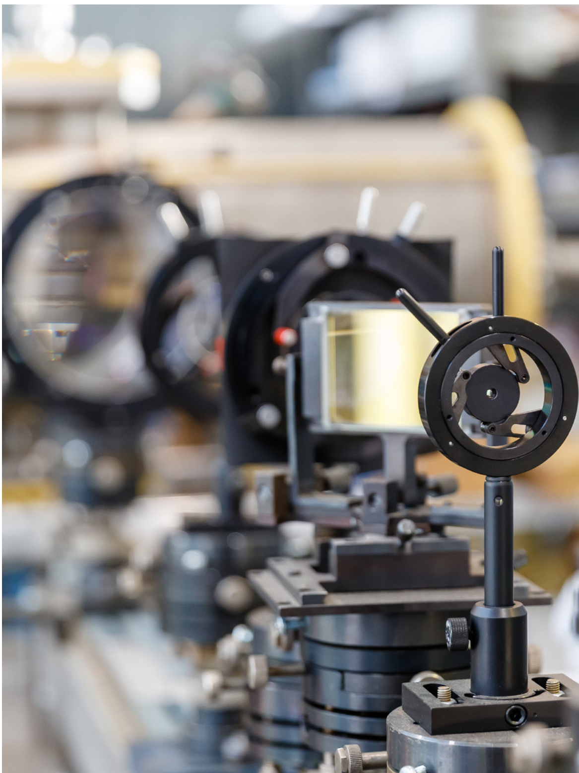
▲ Стенд лазерной интерферометрии, на котором испытывают клапаны для электрореактивного двигателя, ГНЦ РФ ТРИНИТИ
