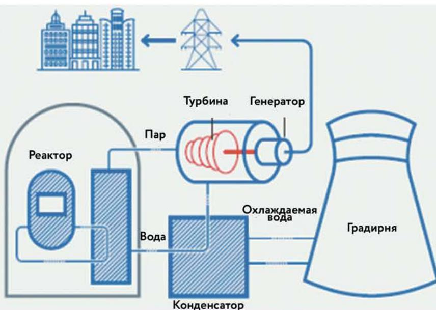
Рис. 3 – Принципиальная схема энергоблока ВВЭР-1200
