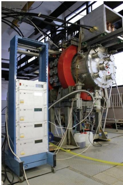
Рис. 16.10. Внешний вид экспериментального стенда для обработки метода плазменной сепарации веществ, моделирующих ОЯТ
