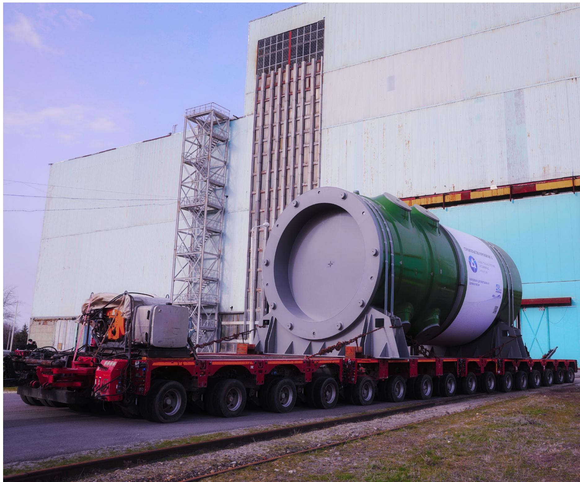
▲ Прибытие корпуса реакторной установки ВВЭР-ТОИ для первого блока Курской АЭС-2
